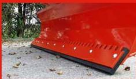
Gumový břit pro shrnování na tvrdém povrchu nebo dlažbě.
