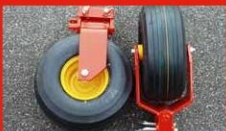
Velká otočná kola s balonovými pneumatikami. 15 x 6.00.
