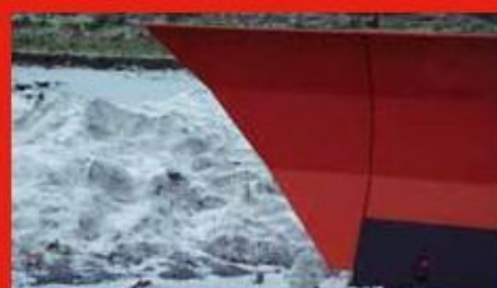
Křídlo na sníh se šikmou hranou, která brání přepadávání sněhu za radlici.
