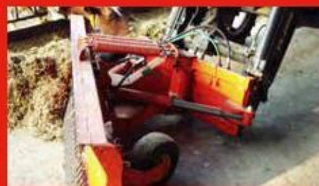
Teleskopické písty na rozšíření úhlu až na 35° pro model GT-FL.
